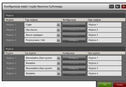
Rysunek 3: Okno konfiguracji wejść i wyjść Neuronu Cyfrowego
