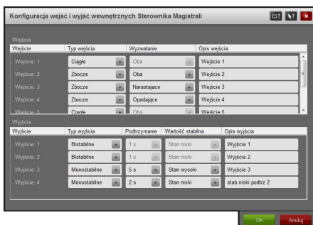
Rysunek 4: Okno konfiguracji wejść oraz wyjść wewnętrznych SM
